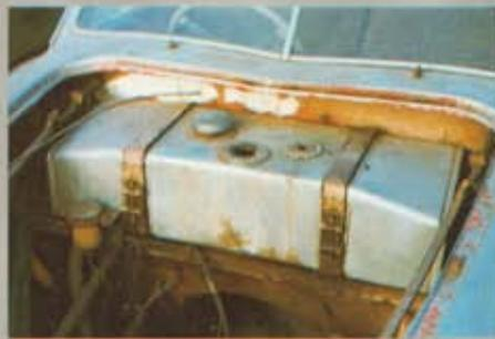
*Il serbatoio in alluminio delle berlina -202-, alloggiato nel vano motore, è caratterizzato da entrambi i lati obliqui per consentire l'apertura del cofano da destra o da sinistra.*
