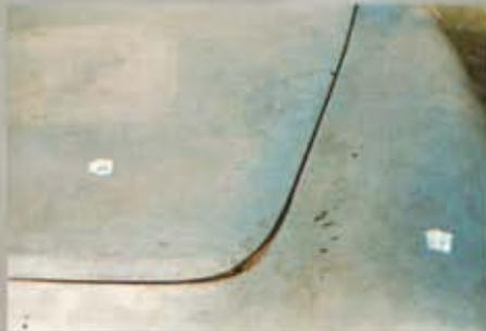
*L'analisi spettrografica si rende necessaria per verificare l'originale fattura di ognuno dei particolari: le zone di diverso colore di cofano e parafrangente verranno esaminate.*
